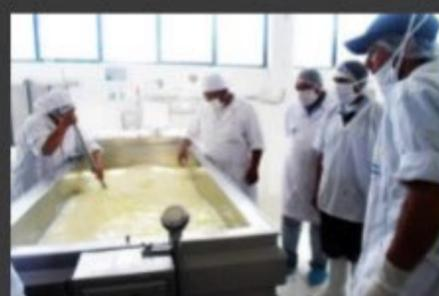
Tecnología de producción de quesos: Recibo de leche en planta, Higienización / Medición / Enfriamiento, Almacenamiento de leche en planta, Estandarización, Pasteurización / Enfriamiento / Traslado de leche, Inoculación, Coagulación, Corte manual de la cuajada, Desuerado, Molienda, Moldeo, Maduración, empaque, expendio
