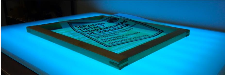
Se utiliza para exponer la malla emulsionada con la transparencia, fijando el diseño en la emulsión.
