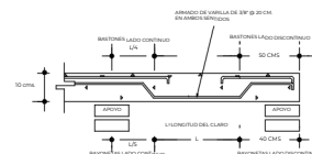
DETALLE DE ARMADO DE LOSA MACIZA DE 10 CMS. AZOTEA
