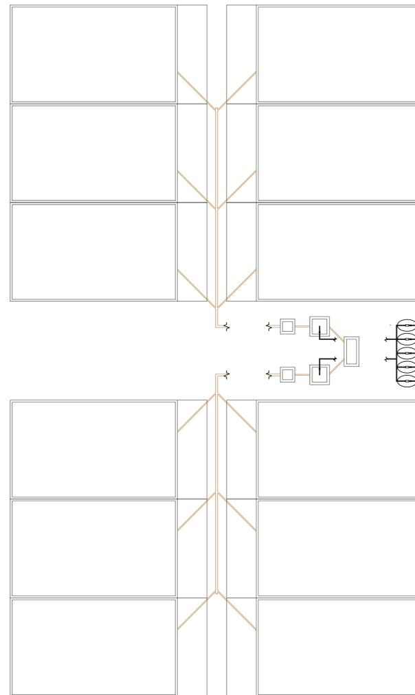
2 BIODIGESTORES CON CAPACIDAD CALCULADA PARA 6 CASAS C/U
