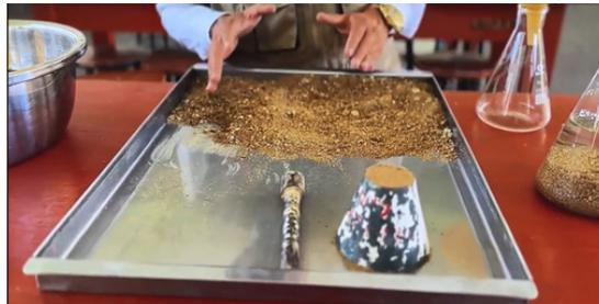
Se sumergieron los agregados en agua durante 24 horas para saturarlos.
