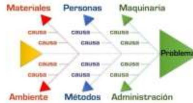
La conclusión del diagrama de pescado (o diagrama de causa y efecto o de Ishikawa) es que permite identificar, analizar y visualizar las posibles causas de un problema específico. Al desglosar las causas en categorías, como métodos, mano de obra, materiales, maquinaria, medición y entorno, se facilita comprender cuáles son los factores que influyen en el problema.
