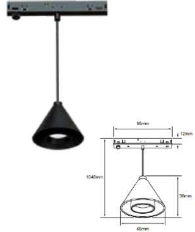
MAGNET SUSPEND CIL II NUEVO 2CTLME073DC30N ■ Negro Luz cálida brillante 3 000 K POTENCIA: 2 W LUMENS: 145 lm VOLTS: 24 VCD Vida útil: 20 000 h IRC: 90 Ángulo: 38° Tipo de lámpara: LED integrado Atenuable: No
