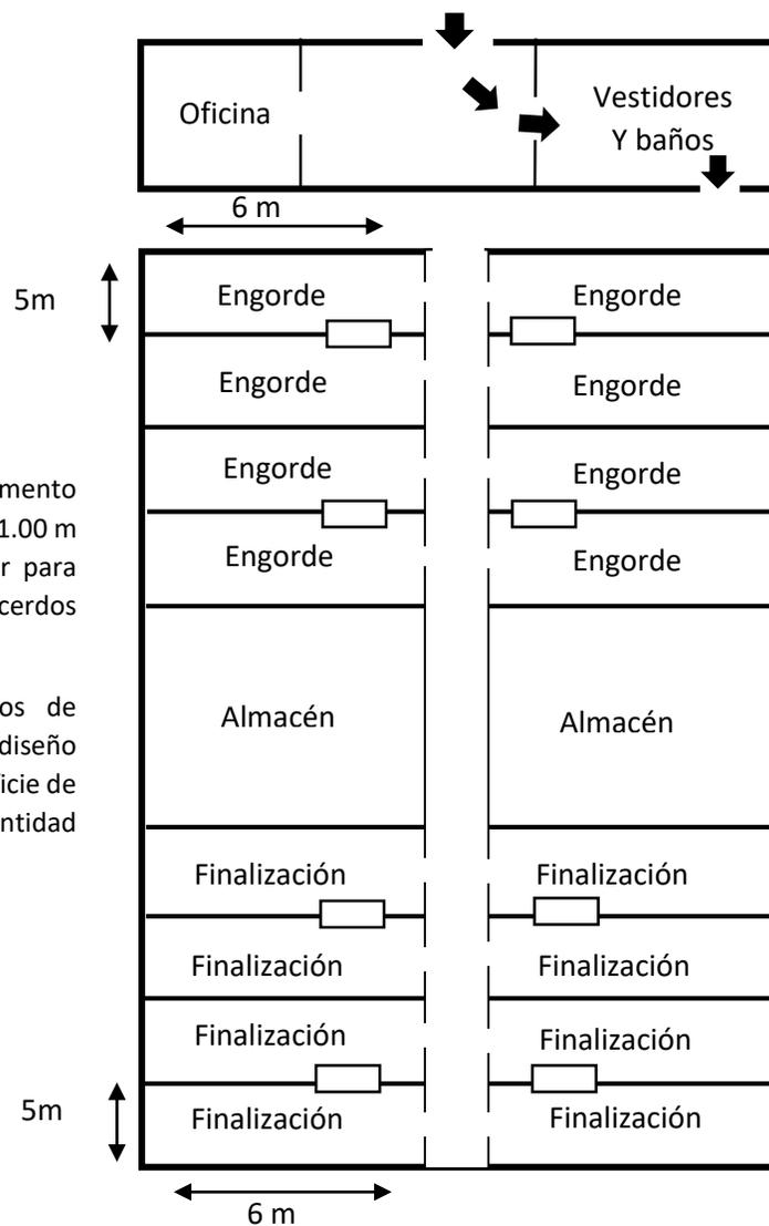
Piso sólido o ranurado de cemento con paredes de block de 0.90 a 1.00 m de altura. Su tamaño debe ser para una capacidad máxima de 25 cerdos por corral.
