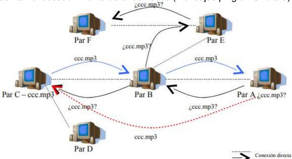
A pesar de que el número de saltos de la red es potencialmente infinito, permanece limitado por un tiempo de vida máximo o TTL, relacionado con el máximo número de saltos que puede dar un mensaje. Por cada nodo o par por el que circula el mensaje de petición se decrementa en una unidad el TTL descartándose la petición si esta llega a cero. En la figura se ve como el par A pide el recurso ccc.mp3 al par B que es el único al que está conectado.
