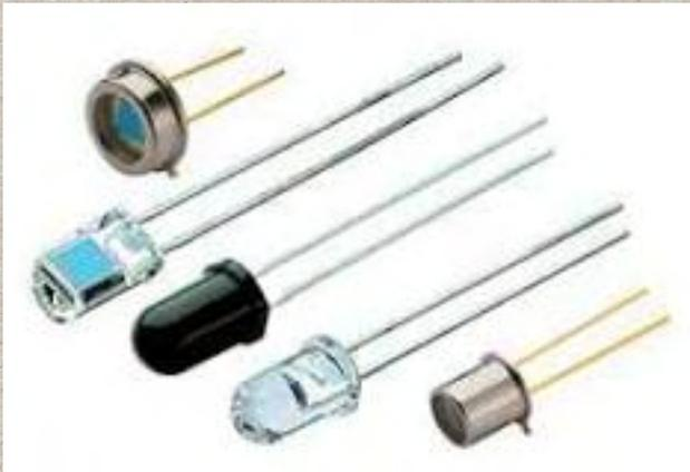
Un fotodiodo es un semiconductor construido con una unión PN, sensible a la incidencia de la luz visible o infrarroja. Para que su funcionamiento sea correcto se polariza inversamente, con lo que se producirá una cierta circulación de corriente cuando sea excitado por la luz.
