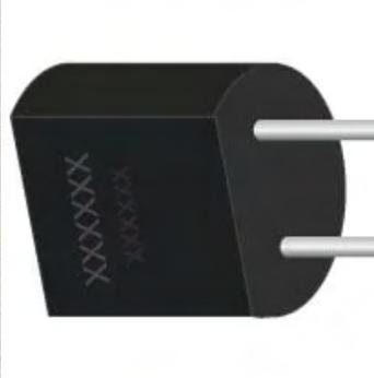
El diodo varicap es un tipo de diodo de unión PN en el que la capacitancia interna puede alterarse como resultado de la aplicación de una tensión de polarización inversa. Siempre funciona en condiciones de polarización inversa y es un dispositivo semiconductor dependiente de la tensión.
