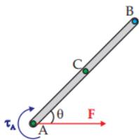
Por otro lado, los efectos de rotación no cambian si en A se aplica un par equivalente, igual al torque de la fuerza aplicada en B y evaluado respecto al punto A, o sea
