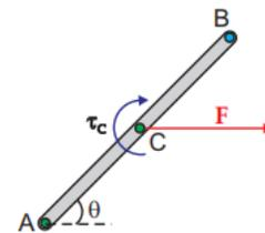
De los dos resultados anteriores se observa que el torque del par es diferente al tomar distintos puntos. Esto debe ser así ya que la fuerza tiende a imprimir diferentes efectos de rotación respecto a puntos distintos. Sin embargo, independientemente del punto donde se aplique el sistema fuerza-par equivalente, los efectos de traslación no cambian siempre y cuando no se cambien la magnitud ni la dirección de la fuerza dada.
