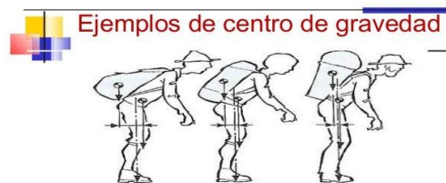
Cuanto más cerca del centro de gravedad corporal se encuentre la carga, más fácil será llevar la mochila.
