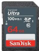
Tarjeta SD: sirve para almacenar datos de manera segura se puede introducir a varios dispositivos y así ampliar su memoria
