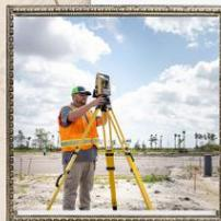
EDM o medición de distancia electromagnética: la medición electrónica de distancia (EDM) es un método para determinar la longitud entre dos puntos, utilizando cambios de fase, que ocurren cuando las ondas de energía electromagnética viajan desde un extremo de la línea al otro extremo.
