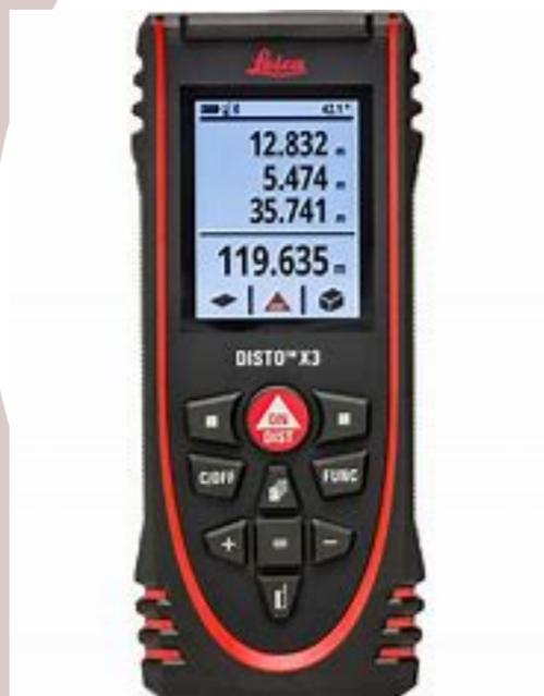
Los distanciómetros electrónicos determinan la distancia en términos del número de ondas, moduladas con frecuencia y longitud de onda conocida, que caben entre el emisor y el receptor en ambos sentidos
