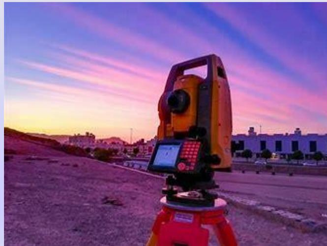
•**Estación total:** Esta es una herramienta de medición de posición angular y de distancia. Esta herramienta se utiliza para determinar la ubicación de puntos específicos en el terreno.
