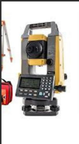
ESTE DISPOSITIVO COMBINA UN TEODOLITO ELECTRÓNICO CON UN DISTANCIÓMETRO, LO QUE PERMITE MEDIR ÁNGULOS Y DISTANCIAS SIMULTÁNEAMENTE. ES UNA DE LAS HERRAMIENTAS MÁS PRECISAS EN LA TOPOGRAFÍA ACTUAL, YA QUE REDUCE CONSIDERABLEMENTE EL MARGEN DE ERROR EN LAS MEDICIONES.
