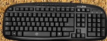
EL TECLADO ES UNA ENTRADA DE INFORMACION Y VA CONECTADO EN LOS PUERTOS USB SI ES ESTE TERMINAL O CONEXION PS2
