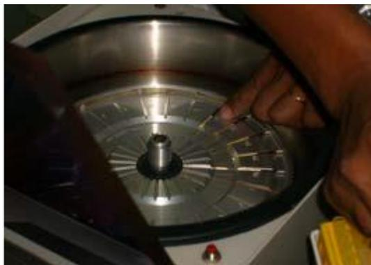
FIG 20. Colocación del tubo capilar en la microcentrífuga
