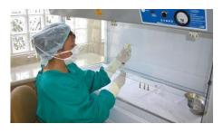
Las manos del operador deben estar lo mas cerca posible de la salida de aire, mantener envases abiertos cerca de el y eliminar obstáculos que interfieran de aire delante del embace de la mezcla. Las jeringas deben ser abiertas por el extremo donde se encuentran las solapas, si hay que abrir ampolletas de vidrio el cuello se desinfecta previamente con alcohol y se abre
