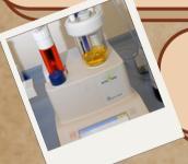
El método de Karl Fischer es el único método químico comúnmente usado para la terminación de agua en alimentos que precisamente se basa en su reactivo
