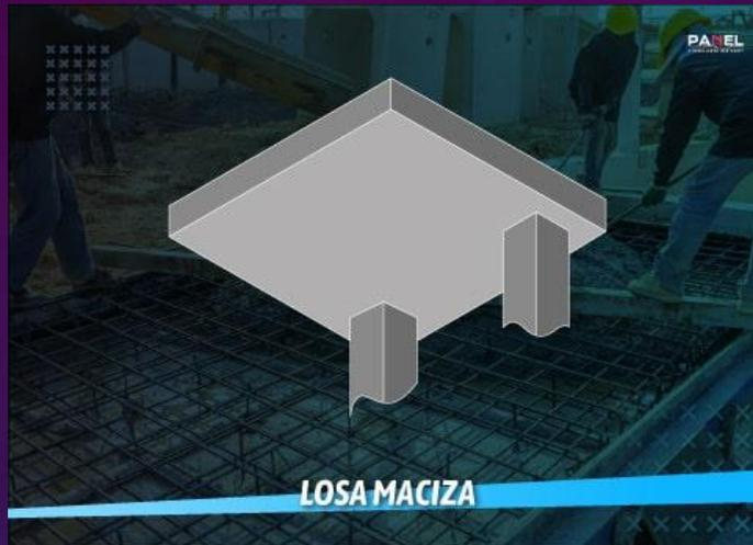
Las losas macizas para casas son elementos conformados durante el proceso de construcción, las cuales presentan espesores de 7 a 15 centímetros normalmente. Su elaboración se lleva a cabo a partir de un encofrado, mismo que constituirá el molde donde se verterá el concreto sobre una armadura metálica.
