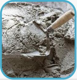
Mortero. El mortero de cemento es un material de construcción obtenido al mezclar arena y agua con cemento, que actúa como conglomerante
