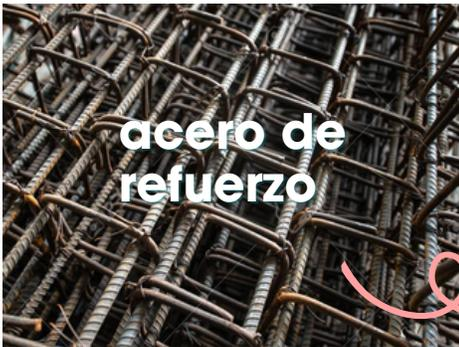
El acero de refuerzo, también conocido como acero de armadura o barras de refuerzo (rebar en inglés), es un tipo de acero utilizado en la construcción para reforzar el concreto y darle mayor resistencia a la tracción. El concreto, aunque es muy fuerte en compresión, es débil en tracción, por lo que se usa el acero de refuerzo para compensar esta debilidad.
