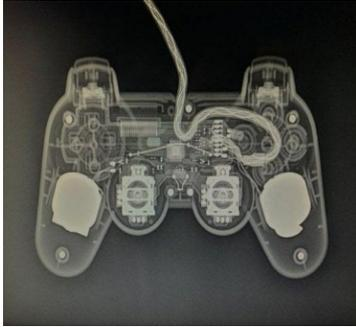
6. Radiografía de un control de play station con forma cercana a una mariposa, donde se aprecia una carcasa de plástico unido a un cable de corriente eléctrica que en su interior se encuentran los botones y joysticks que sobresalen y se aprecian unas piezas metálicas en la parte inferior,
