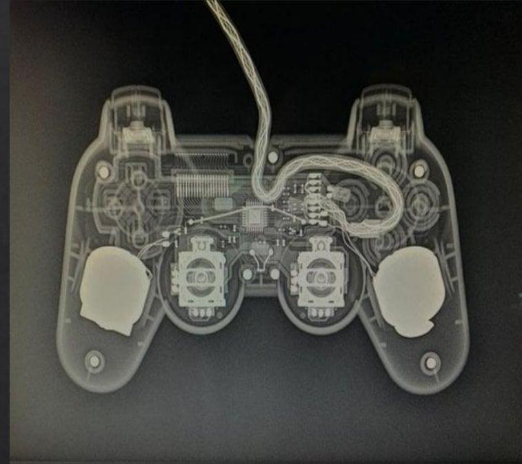
Se observa una radiografía frontal de un control que se deduce que es de playstation, en la parte superior presenta los cables junto a los , en la parte baja vemos los joystick y se nota que está bien ensamblado
