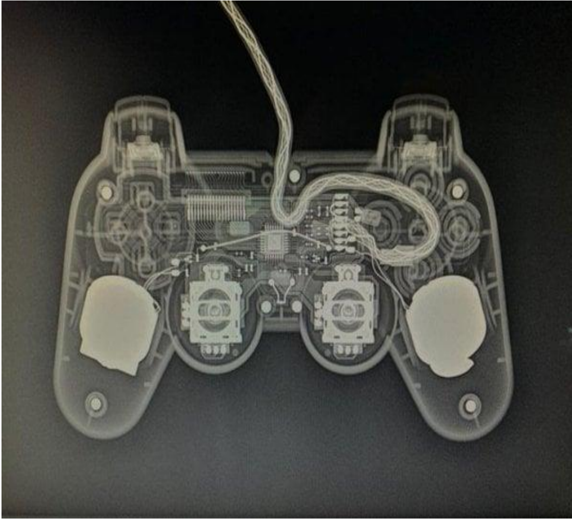
Imagen 6: se aprecia un control de play station inalámbrico en vista anterior, cuenta con sus estructuras internas con mayor radiopacidad, así como estructuras externas que son los gatillos de ambos lados, los joystick, la cruz y el cable que se conecta al dispositivo
