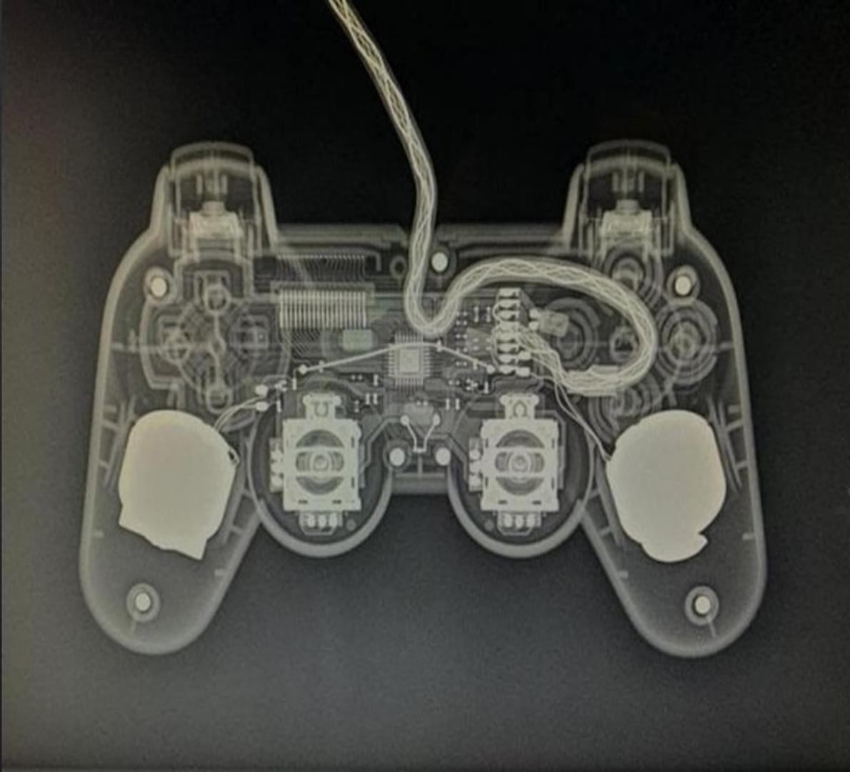
Es una radiografía de un control para videojuegos, podemos observar los tornillos, los cables, los paneles y la forma de los botones.
