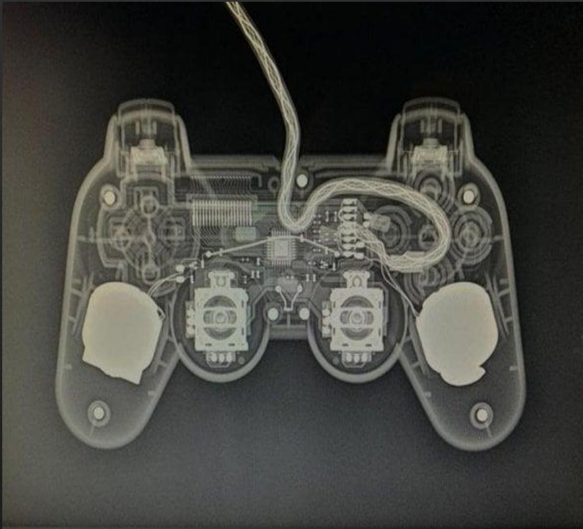
Se observa radiografía transversal de un control de videojuegos en donde se observa la carcasa además de 5 tornillos, se observan cables, botones y otros componentes para un buen funcionamiento.
