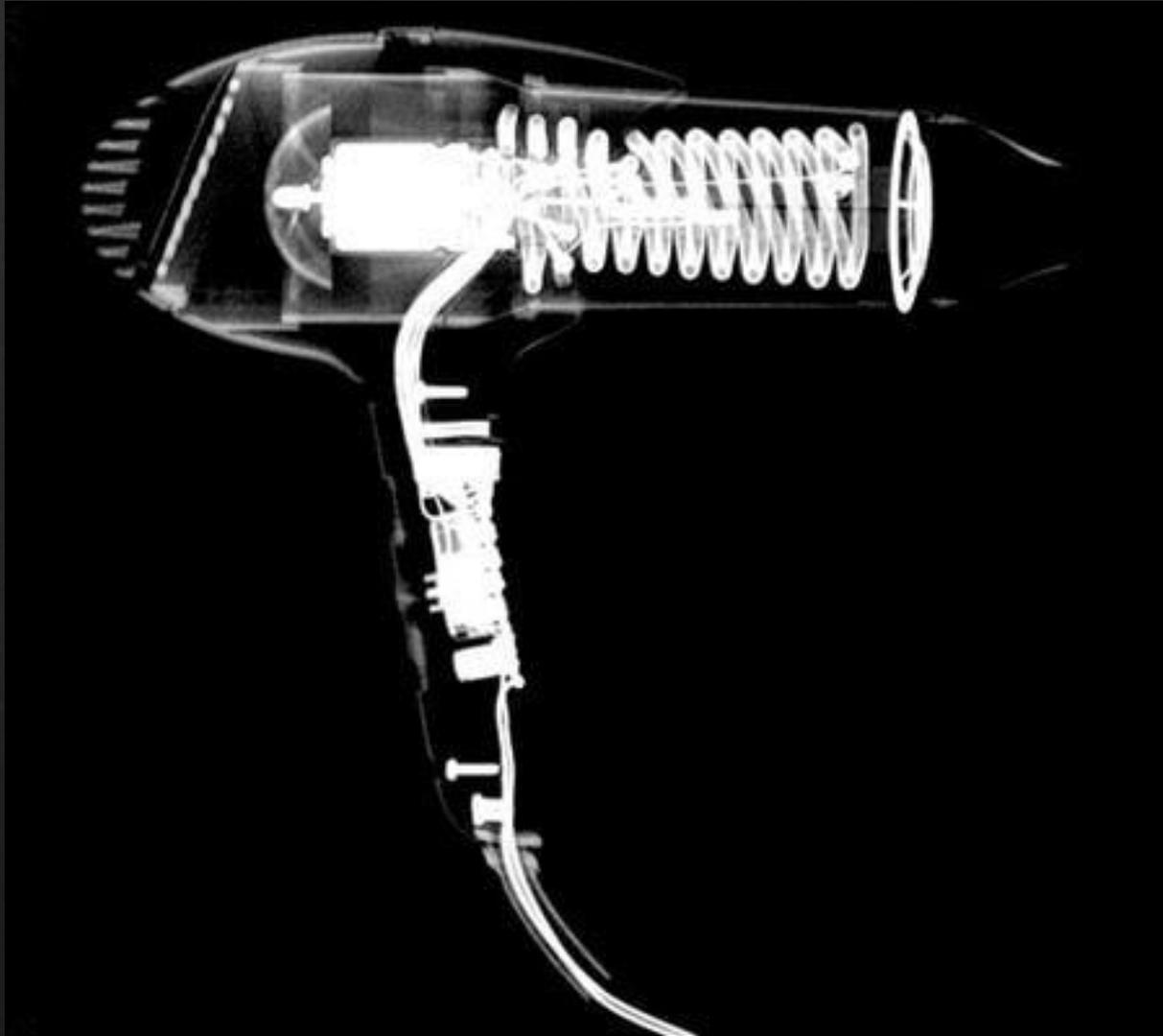
Se observa radiografía lateral de secadora de cabello en la cual se puede observar es de carcasa plástica, presenta una boquilla estrecha para la salida de aire, una rejilla para filtrar el aire, una tipo extensión para calentar, además de un motor y por la parte trasera orificios para la entrada de aire, en la parte del mango se observa el interruptor, los tornillos para sujetar la carcasa y el cable de alimentación.
