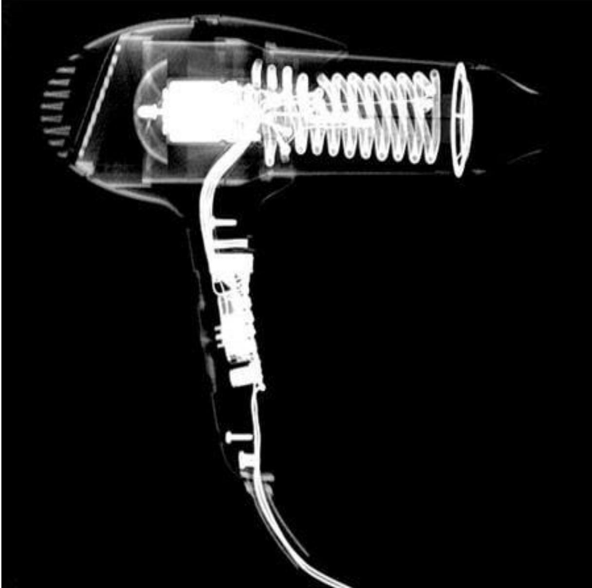
Se observa una radiografía con un corte lateral de una secadora desde el exterior podemos observar la carcasa por dentro podemos su flujo de aire la rejilla donde sale el aire se puede ver el motor eléctrico la resistencia eléctrica, las aspas se pueden ver cables el interruptor para encenderlo y apagarlo sus cables y tornillos
