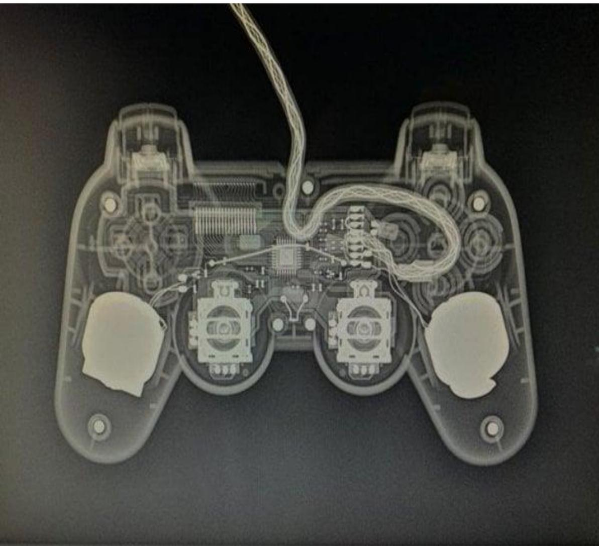
Se observa una radiografía con un corte coronal de un control de play station donde podemos observar los mandos los gatillos de R1 R2, L1 y L2 podemos observar los joy sticks el panel central ,podemos observar el cable inalámbrico que está conectado sus circuitos
