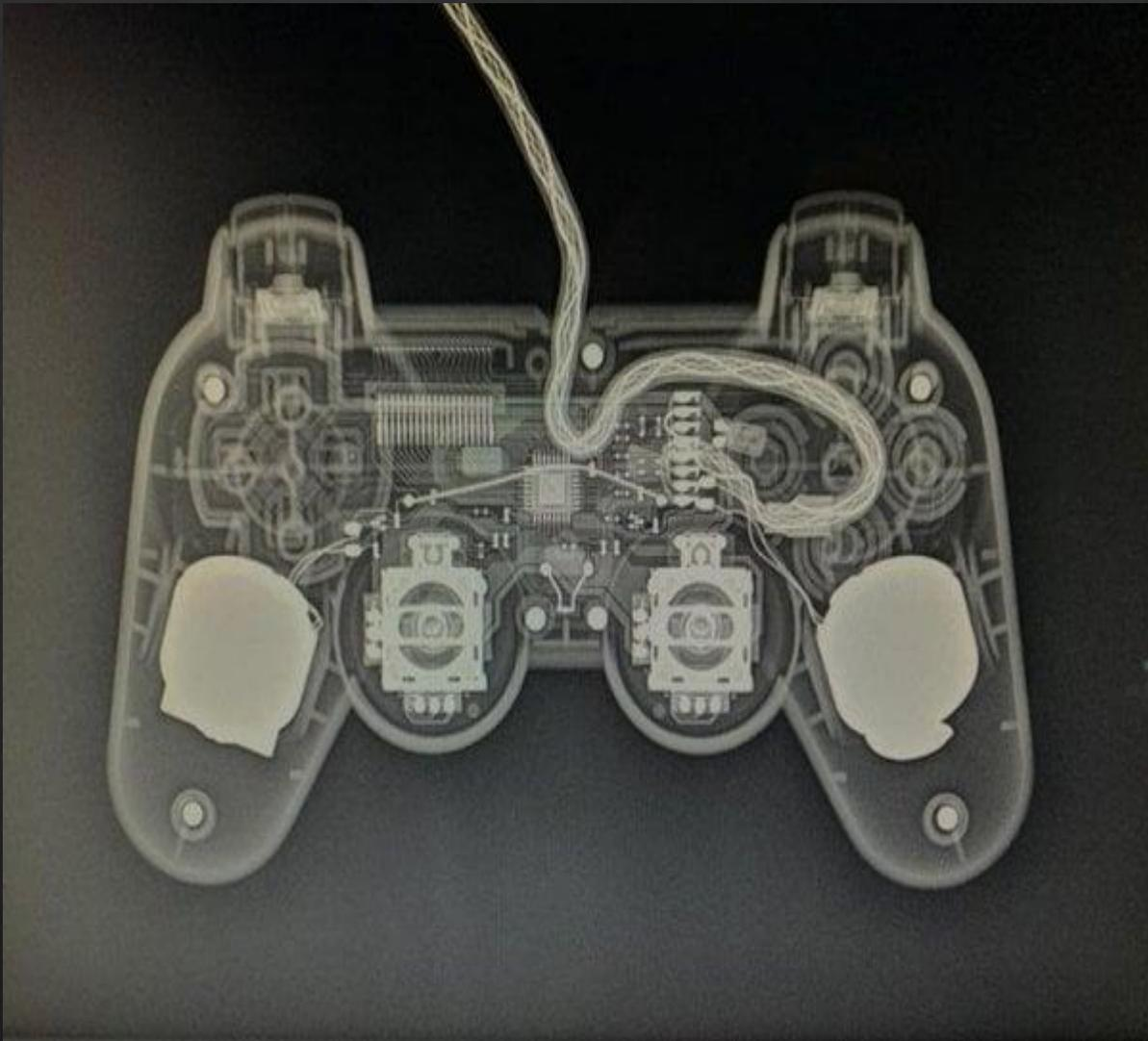
Se observa radiografía de un control de videojuegos, se observa 7 tornillos en las partes distales del control, en la parte superior se observa el cable de salida para la alimentación de energía y se observa 2 botones sobresaliente de la carcasa del control, en la parte central se observa la placa de control donde se encuentran todas las conexiones para su funcionamiento y se observa los joystick de jugabilidad.
