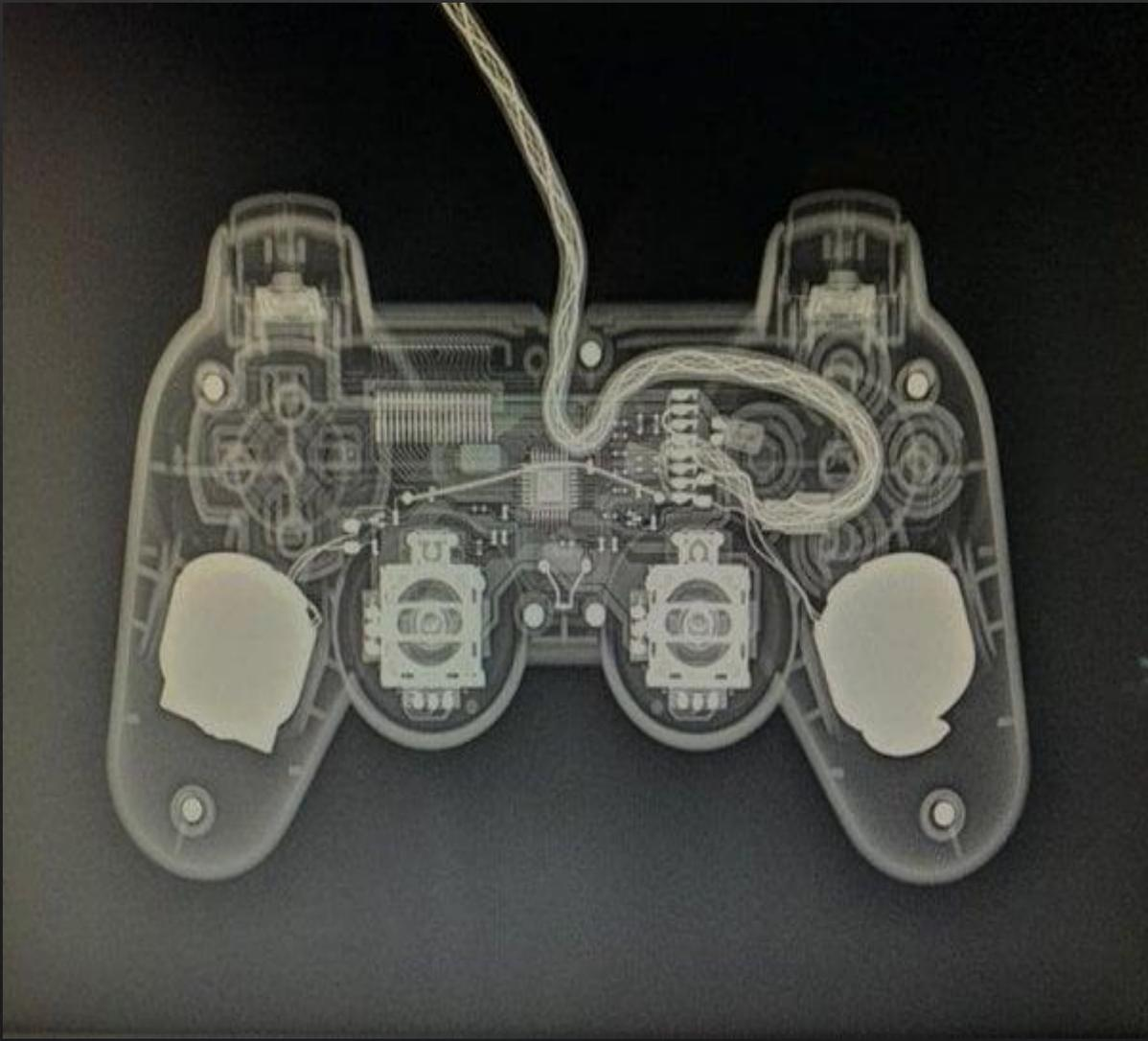
**En la radiografía se observa un control de PlayStation, se observa el cable cable de corriente por lo cual sabemos que es un control alámbrico, también se ven los gatillos del mando, los botones y joysticks de ambos lados, se distinguen los tornillos de ensamblaje, así como los motores de vibración y la placa madre.**
