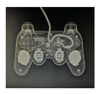
Se observa una radiografía de un control de videojuegos de manera frontal, se logran observar los cables que generan la electricidad, los circuitos donde van los botones, se logran observar unos tornillos lo que da el soporte, y también se logra observar un resorte y el cable que da la corriente
