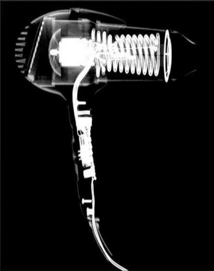
Se observa radiografía de maquina de secado manual, in la parte interna con dispositivo para la sida de aire y circuito de calentamiento de aire en forma espiral y una estructura cilíndrica, en la parte trasera se observa un panel para la introducción de aire en la parte media se observa cable para alimentación eléctrica y dispositivo de encendido y apagado y en la parte inferior se observa el mango de agarre y el acle de conexión.
