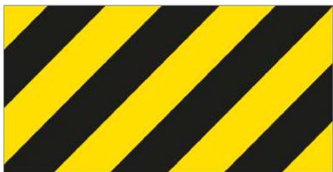
La **disposición del color amarillo** para la identificación de fluidos peligrosos, se permitirá mediante bandas con franjas diagonales amarillas y negras a 45°.
