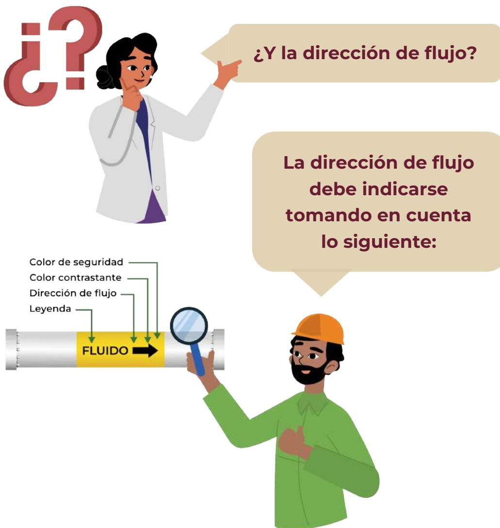
La dirección del flujo debe indicarse con una flecha adyacente a las bandas de identificación, o cuando la tubería esté totalmente pintada, adyacente a la información complementaria. Las tuberías en las que exista flujo en ambos sentidos, se identificarán con una flecha apuntando en ambas direcciones. La longitud de la flecha será igual o mayor a la altura de las letras de las leyendas en relación al diámetro de la tubería.
