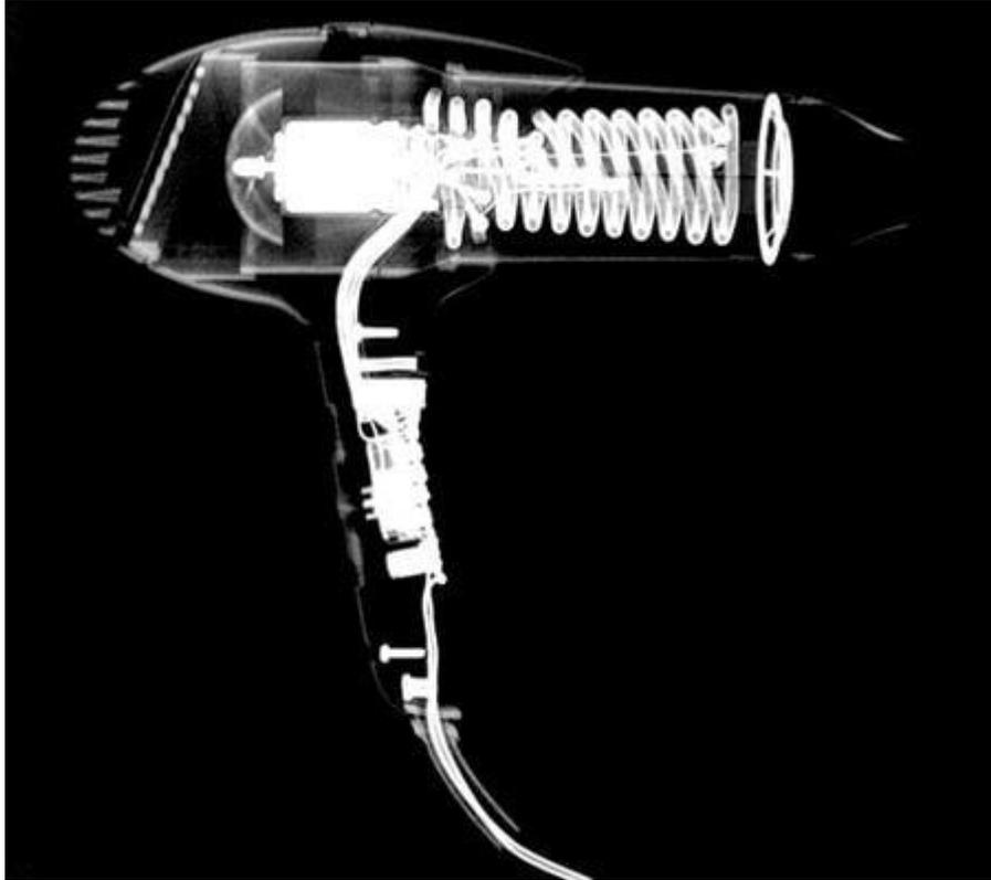
Radiografía lateral de un objeto de forma similar de una secadora, se observa la boquilla de salida, resistencia en forma de espiral , un motor , así como toda el perímetro de la carcasa , ventilas de aire , en la región del mango se observa un interruptor y el cable de conexión a la energía eléctrica.
