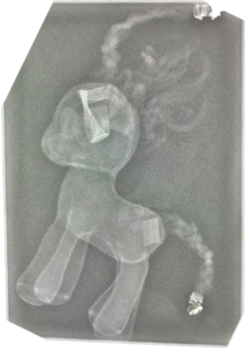
Se observa radiografía corte lateral , con objeto con forma similar al de un caballito de juguete, se asume que de un pony , con presencia de posibles extensiones de cabello una en la parte superior y una en la parte inferior posterior asi mismo se presentan en cada extremo de las mismas un nudo, imagen lineal de la posible etiqueta en la parte inferior posterior.
