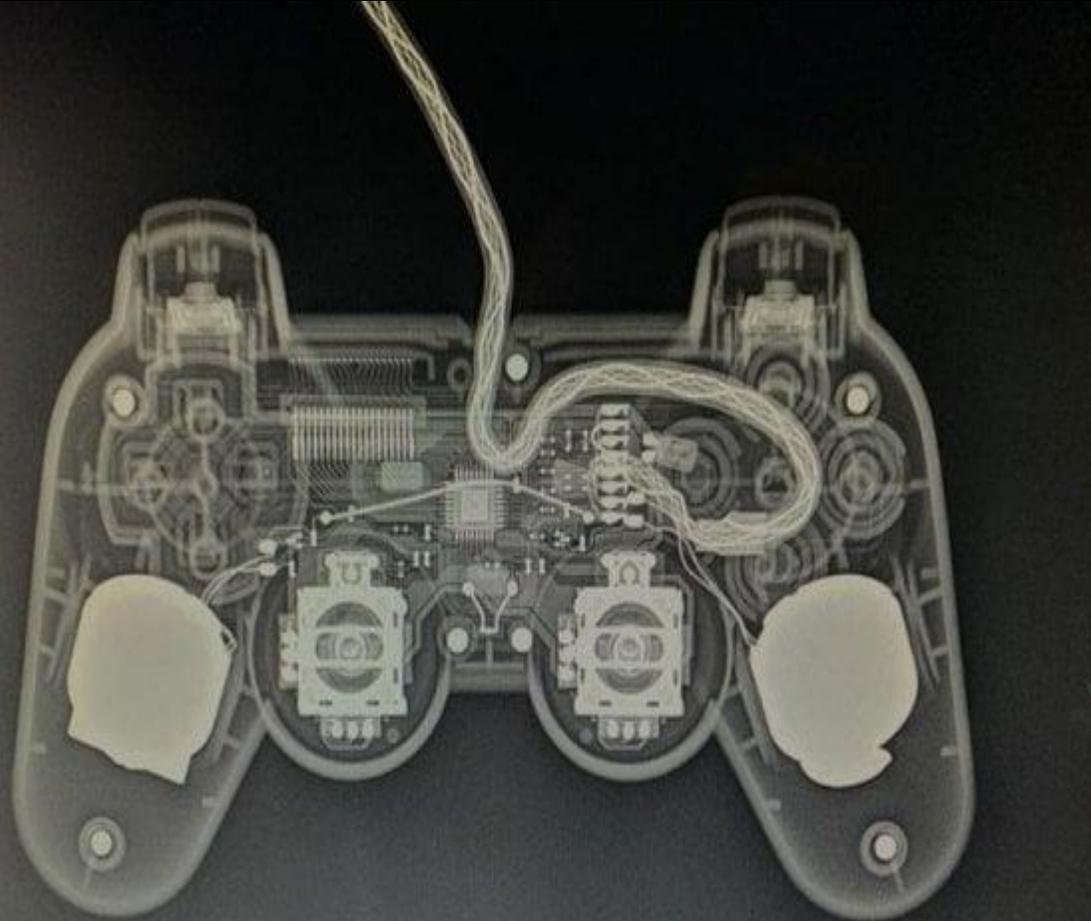
Radiografía de un control para Xbox donde se observa un cable, cajas de circuito, botones, tornillos
