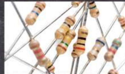
su trabajo es ofrecer resistencia al paso de la energía, con la intención de controlar la potencia, disminuir el voltaje, o generar calor.
