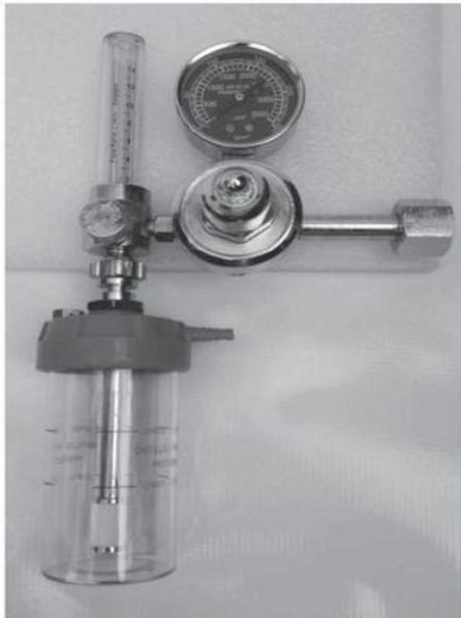
Humidificadores simples: En estos sistemas, la humidificación se logra cuando el gas pasa a través del agua. Hay dos tipos, el humidificador en línea y el de burbuja.
