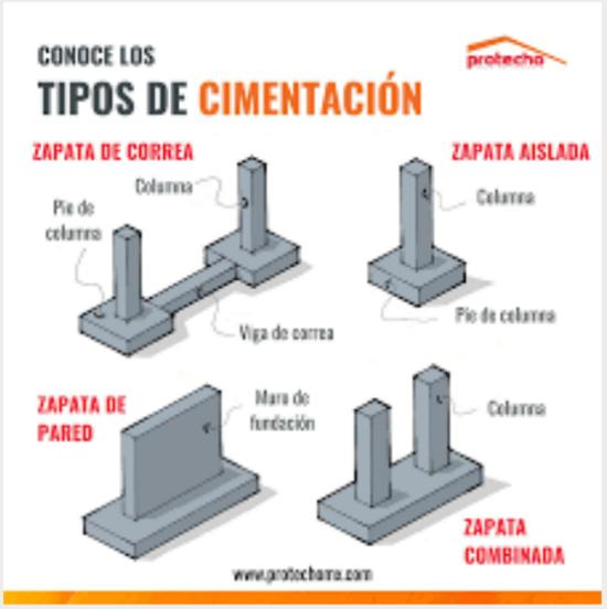
Una zapata es un tipo de cimentación superficial, que puede ser empleada en terrenos razonablemente homogéneos y de resistencias a compresiones medias o altas. Consisten en un ancho prisma de hormigón situado bajo los pilares de la estructura.
