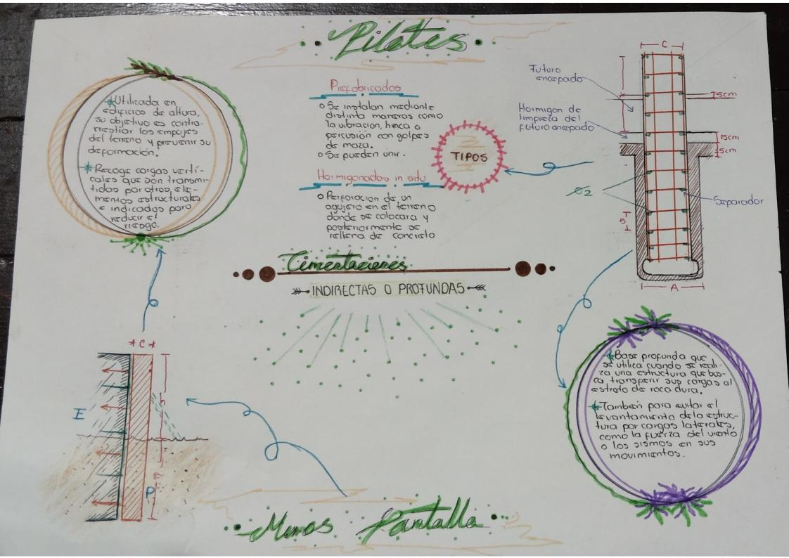
"Carsson" Se utilizan en suelos blandos, o para cimentar pilares de piantes en el cause de rios. se va construllendo a medida en que se va hundiendo en el terreno Mantions una forma circular. \*\* INTERMEDIAS - « Relleno compactado -Relleno Compadado Plantilla de concreto pobre Separadores Zapala Separadores Hormigón Pobre
