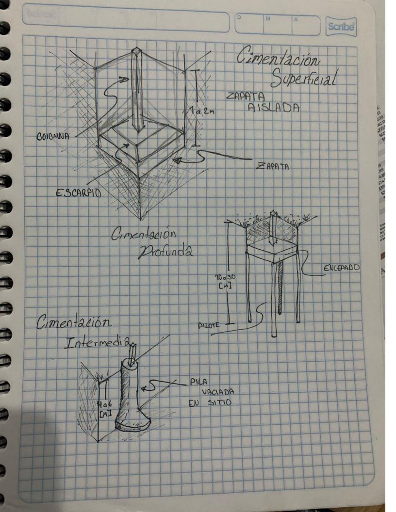
Las **cimentaciones superficiales** son aquellas en las que el ancho de la base es mayor con respecto a la profundidad de la base, es decir, la superficie en la que se apoyan los elementos tiene un área mas extensa que la cota vertical
