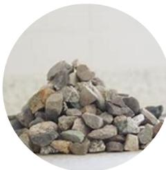
**POR SU TAMAÑO.** Agregado grueso. Agregado retenido de modo predominante por el tamiz No. 4 (de 4.75mm); o bien, aquella porción de un agregado que es retenida por el tamiz No. 4 (de 4.75 mm)
