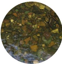
Adquiere las características físicas del material de cantera por el proceso de trituración, pero conserva las cualidades mecánicas, propias como resistencia al desgaste y al intemperismo, que tenía el material de río que le dio origen.
