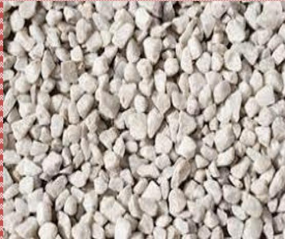
**SE CONOCE COMO AGREGADO GRUESO AL MATERIAL PROVENIENTE DE LA DESINTEGRACIÓN DE LA ROCA DE ORIGEN VOLCÁNICO Y QUE POR SU TAMAÑO QUEDA RETENIDO EN EL TAMIZ NÚMERO 4 (4.75 MM). ESTÁ ELABORADO BAJO CUMPLIMIENTO DE LA NORMA NTE INEN 872, EQUIVALENTE A LA NORMA ASTM C33.**
