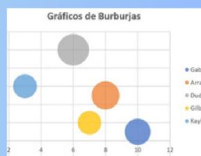
Un gráfico de burbujas es en realidad un tipo de gráfico XY (dispersión). El tamaño del marcador de datos muestra el valor de una tercera variable.
