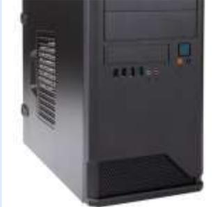
. Los componentes del chasis de la mini torre pueden incluir: bahías para unidades de discos, luces de actividad, ventanas de aire, botón de turbo y reseteo, y seguro de chasis.
