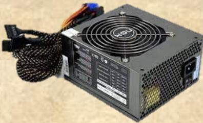
Está pensada para convertir la corriente alterna en corriente continua de un voltaje menor.
