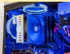
Sistema de refrigeración – Se genera calor a partir del flujo de corriente entre los componentes electrónicos, en donde el funcionamiento va a ser mejor si la temperatura se mantiene baja.
