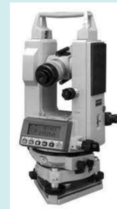
Teodolito electrónico DT4 de Sokkia
