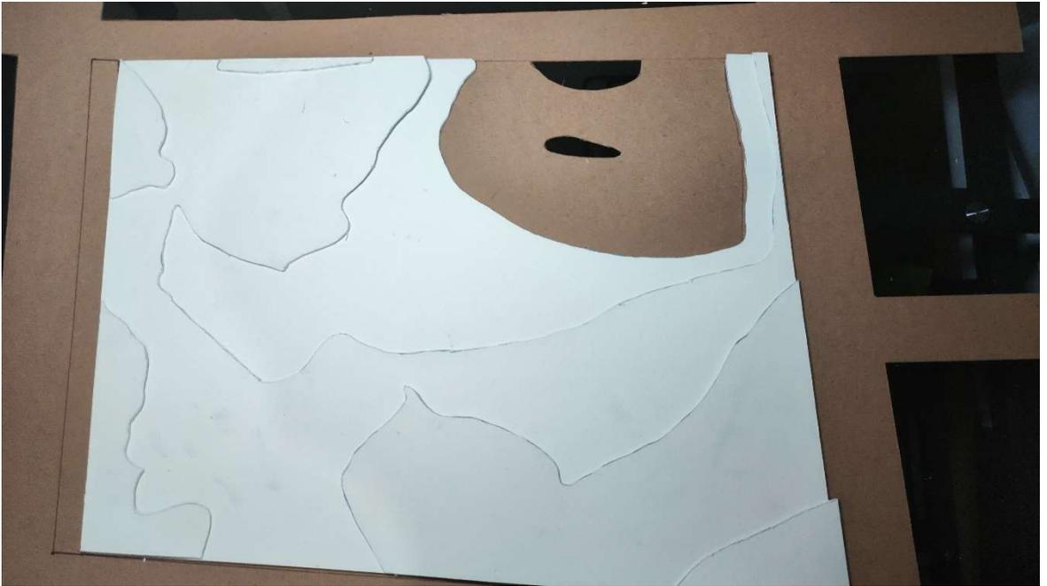
Primeramente, trace el terreno junto con las calles, después de eso recorte las calles dejando libre el área del terreno, posterior a eso empecé a trazar cada cambio de nivel del terreno. Empecé por la capa mas alta hasta llegar a la capa mas profunda, y entre mas profunda era cada capa tenia que recortar casi todo el tamaño del terreno, pero al final conseguí recortar cada cambio de nivel exitosamente.
